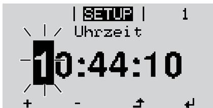
Die Uhrzeit wird angezeigt. (HH:MM:SS, 24-Stunden-Anzeige), die Zehner-Stelle für die Stunde blinkt.
