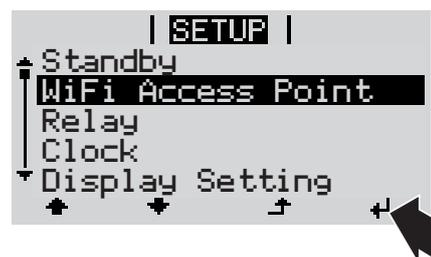
Der Wechselrichter baut den WLAN Access Point auf. Der WLAN Access Point bleibt 1 Stunde geöffnet.
